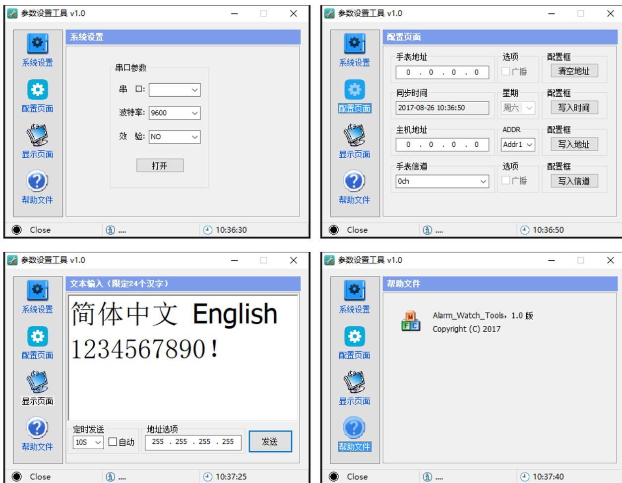
我公司提供用于测试的上位机软件，用户也可以依据“腕表通讯协议”自己做上位机软件。
