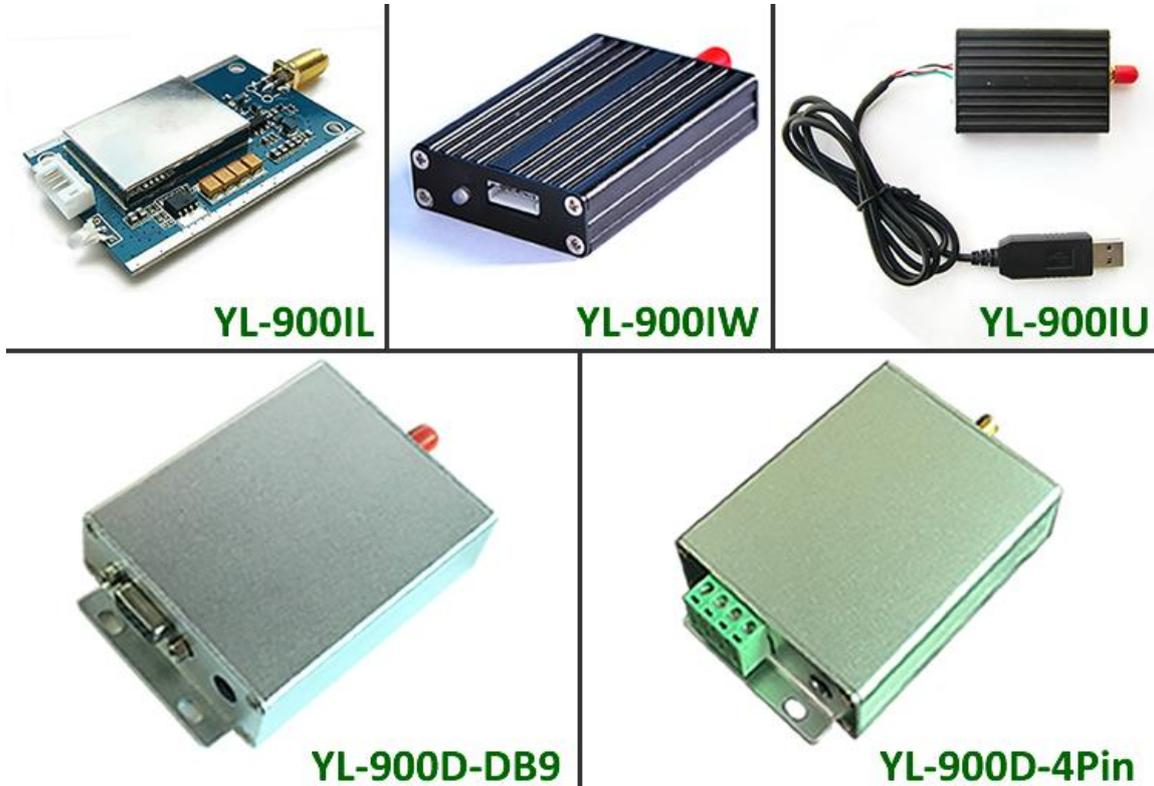
如果使用我公司 YL-900IU 模块作为发射器，需要安装 USB 转 TTL 驱动才能被电脑识别。
