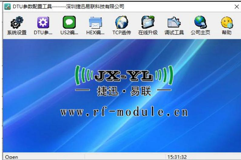
用 USB-TTL 数据线把网关连接到电脑 USB 端口后，点“系统设置”，弹出“串口参数配置页”，选择网关对应的端口号，以 115200 无校验打开。
