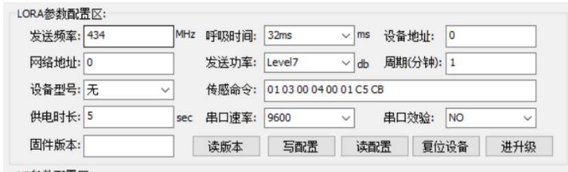
把水浸传感器通过 RS485 数据线接上电脑后，通过磁控开关进入配置模式(将一块磁铁靠拢磁控开关，指示灯常亮，表示已经进入配置模式)，此时采集器处于设置状态，打开“传感器终端配置工具”，点击“串口”，弹出“串口配置页”，选择采集器连接电脑的 COM 端口，用波特率 9600，效验 NO 打开。
