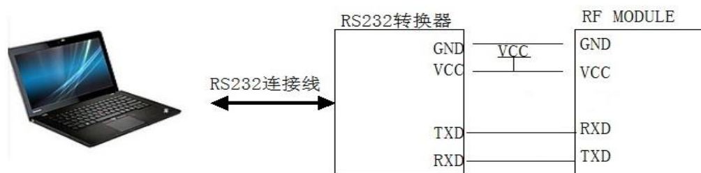
图 8.1 无线模块和电脑连接示意图 (TTL)
