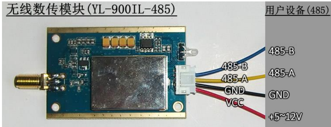
图 7.1 无线模块和用户设备连接示意图 (RS485)
